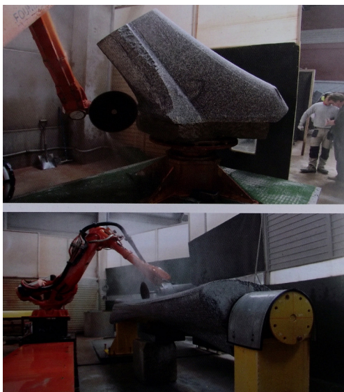
Imagem 27 _ Em cima : atual nartex da Fachada da Paixão; Em baixo : colunas a serem esculpidas por braço robótico através de CNC.
