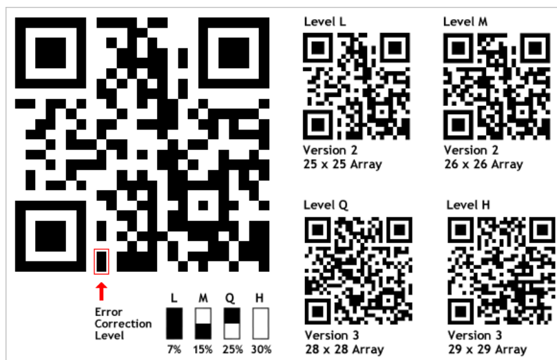
Figura 2.4 – Níveis da correcção de erro para um Código QR.
