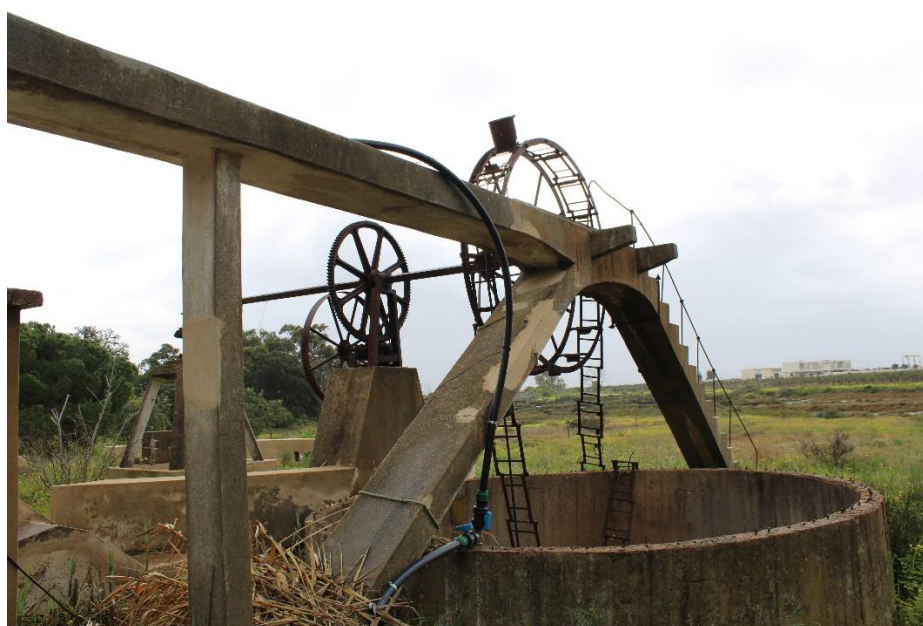
Figura 11 – Sistema de bombagem da água na Quinta da Arábia; elaborado pela autora.
