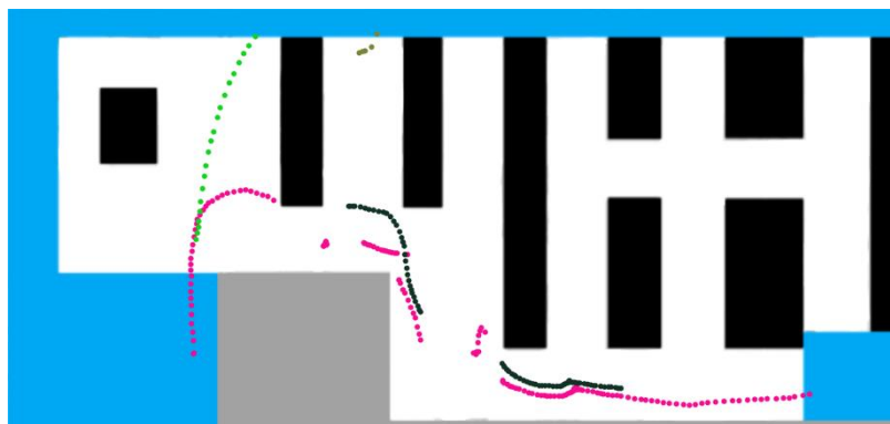
Fig. 4.2 – Exemplo de uma pessoa detetada por câmaras diferentes originando IDs extra
