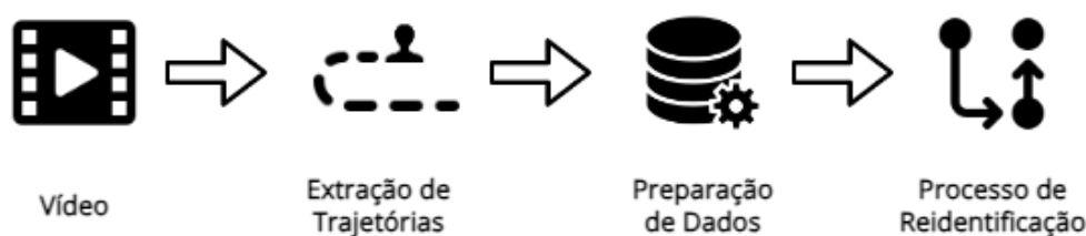
Fig. 3.1 – Esquema geral do pipeline das várias partes do processo de reidentificação
