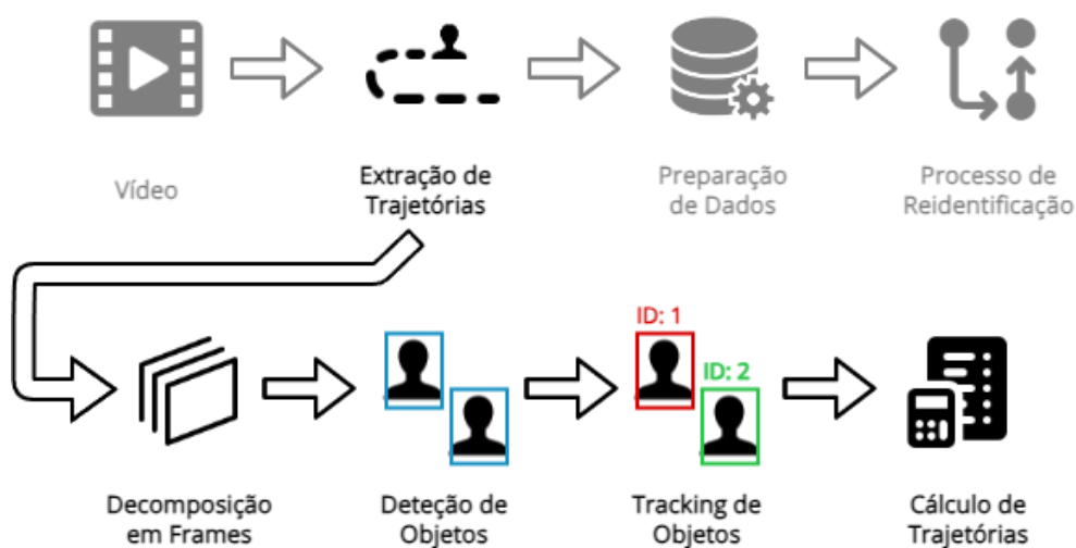
Fig. 3.9 – Esquema do processo de Extração de Trajetórias
