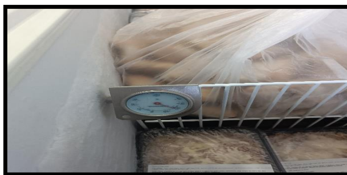
Figura 3.2.12: Termómetro manual localizado dentro da arca frigorífica exclusiva para o acondicionamento de refeições halal da EB. D. Dinis nº1 para controlo exato de temperatura
