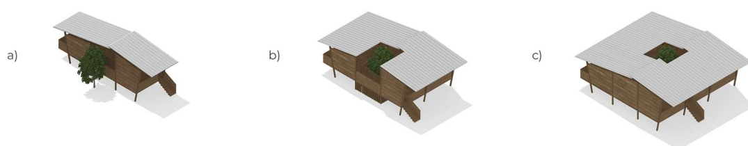
Figura 89 - Perspetiva das fases de extensão dos módulos evolutivos das novas habitações: a) construção das infraestruturas sanitárias, espaço de cozinha, sala de jantar e quarto, b) extensão opcional de um quarto e espaço de convívio, c) extensão opcional de um espaço de entrada, quarto e escritório.
