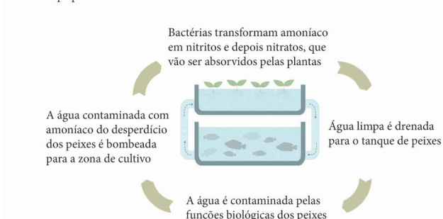
53. Esquemas do funcionamento dos sistemas aeropónico e aquapónico, elaborado pelo grupo, 2022.
