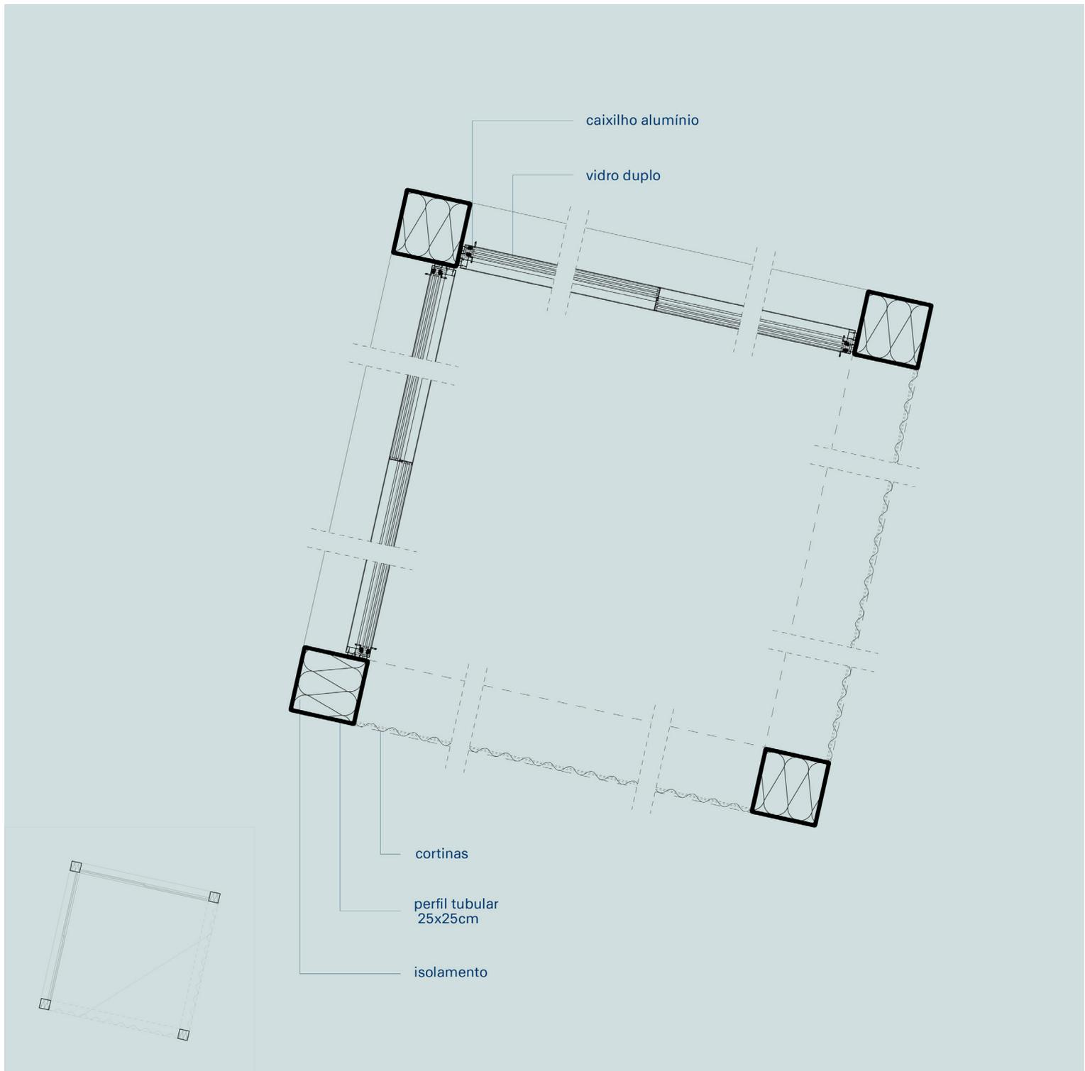
planta construtiva módulo transparente
