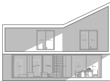
Figura 100 - Alçadocomsombreamen- to: 9h a 21 de Junho
