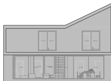
Figura 103 - Alçadocomsombreamen- to: 18h a 21 de Junho
