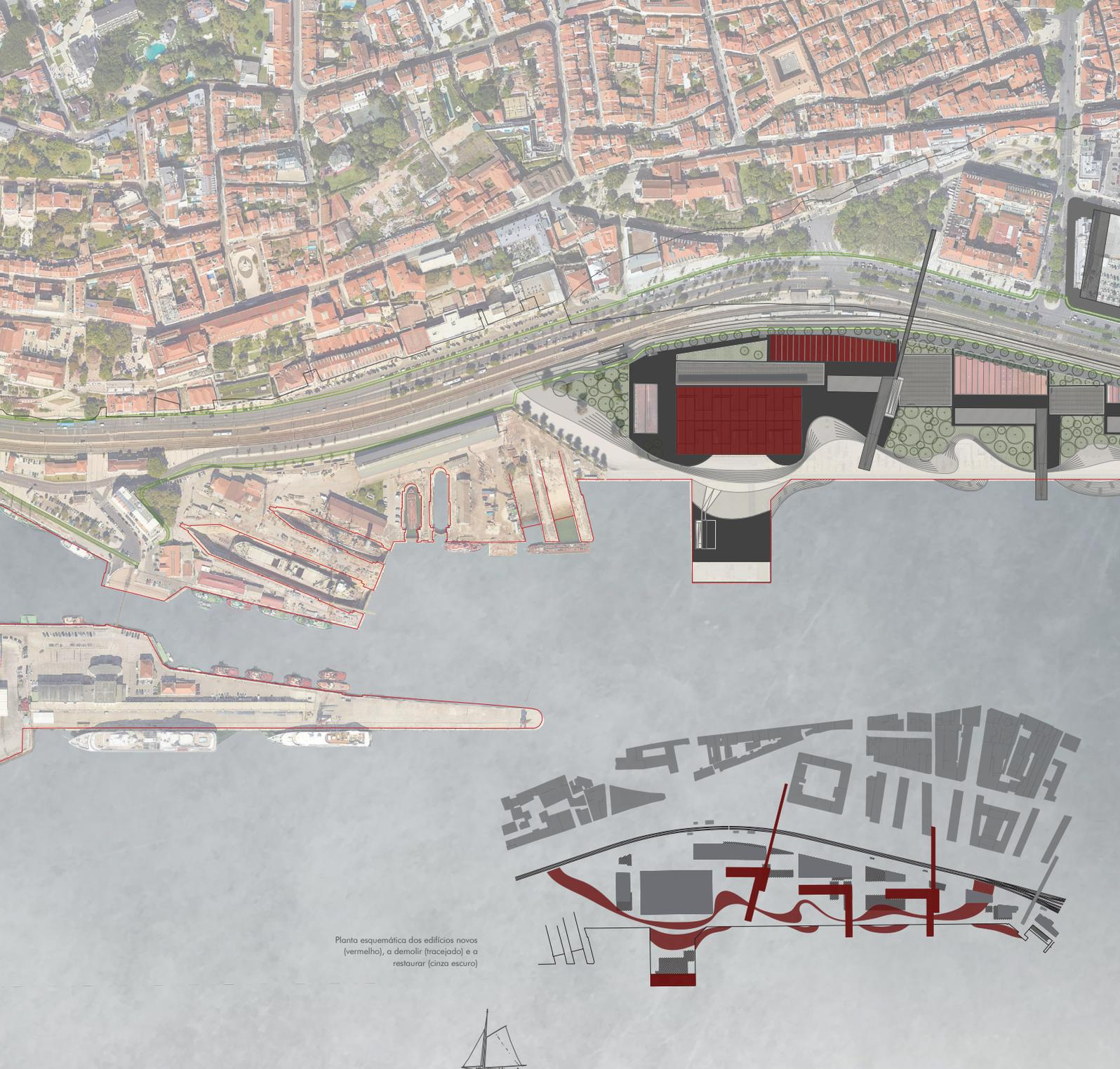
Planta esquemática dos edifícios novos (vermelha), a demolir (tracejado) e a restaurar (cinza escuro)
