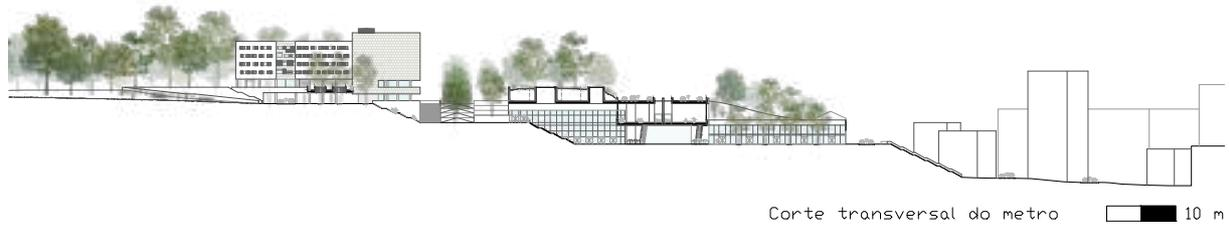
Figura 54 – Corte transversal, nascente-poente, da estação de metro (Fonte: Marco Andrade, 2019)
