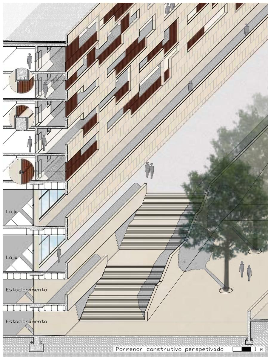
Figura 76 – Pormenor construtivo perspectivado (Fonte: Marco Andrade, 2019)
