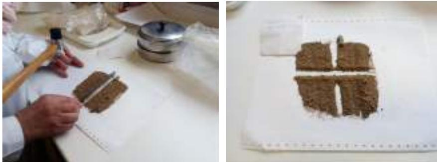
*Figura 83 e 84 - Homogeneizando a amostra (Fonte: Marco Andrade, 2018)*
