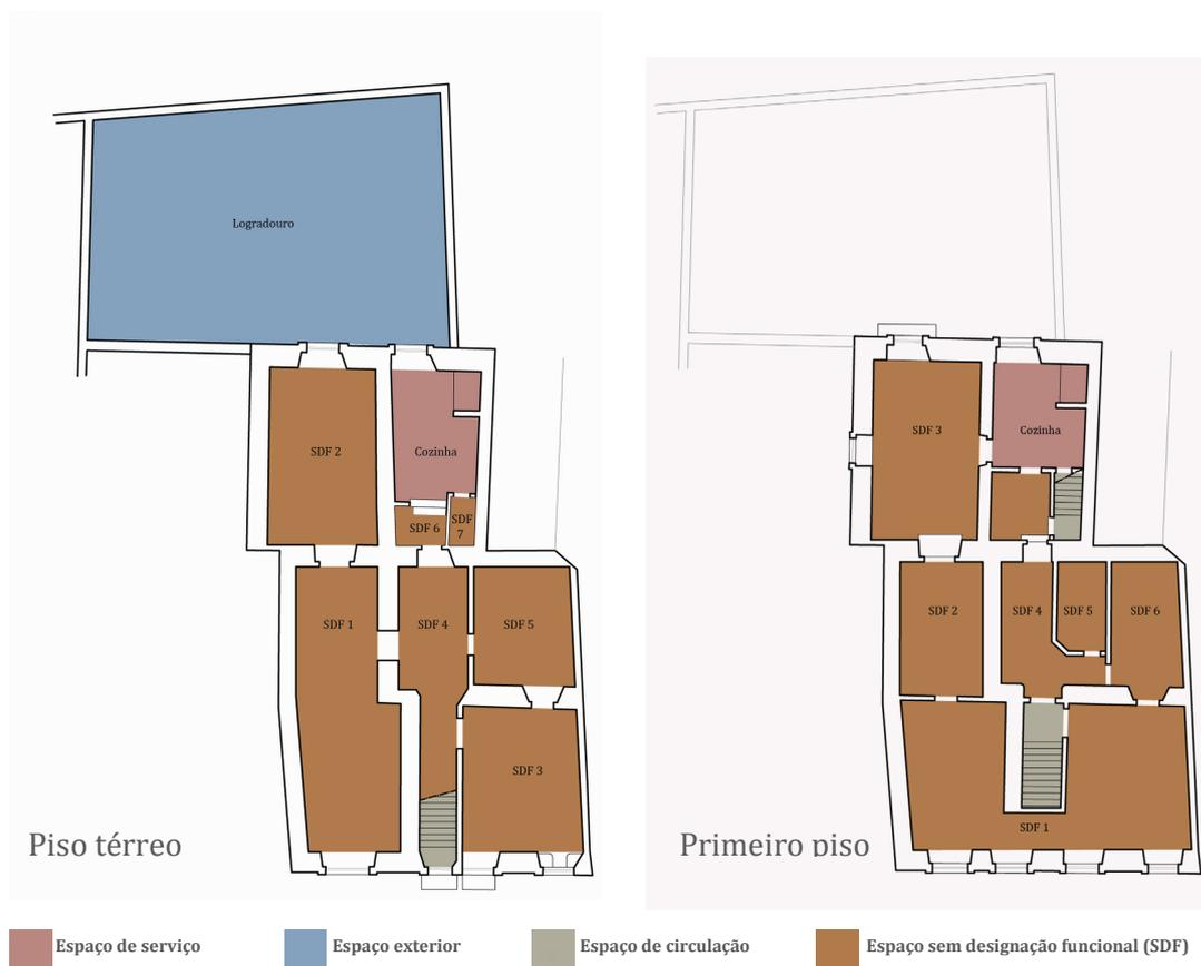
Imagem 37: Planta de distribuição funcional do prédio anterior à 1914. À esquerda planta de piso térreo e à direita planta de primeiro piso. Desenhos realizados com base no levantamento de 1994 e do projeto de alterações de 1914.
