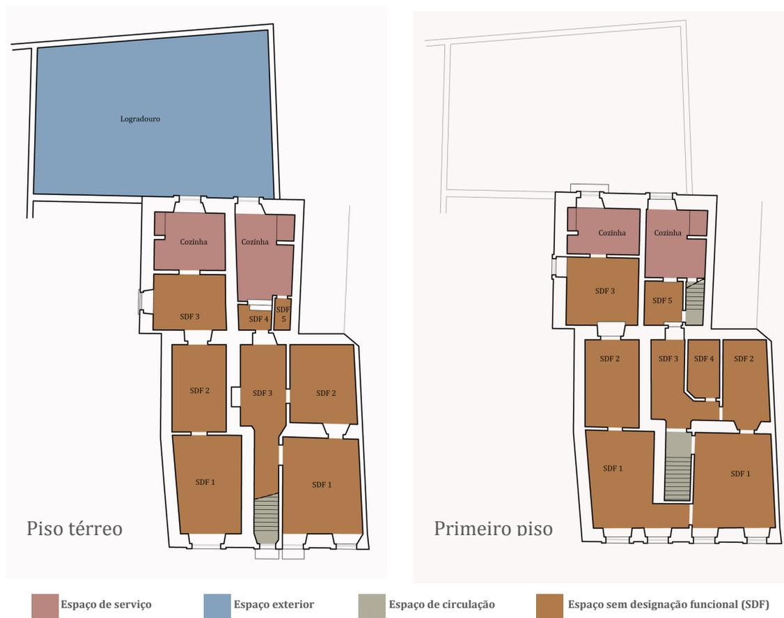
Imagem 40: Planta de distribuição funcional do prédio anterior a 1914. À esquerda planta de piso térreo e à direita planta de primeiro piso. Desenhos realizados com base no levantamento de 1994 e do projeto de alterações de 1914.
