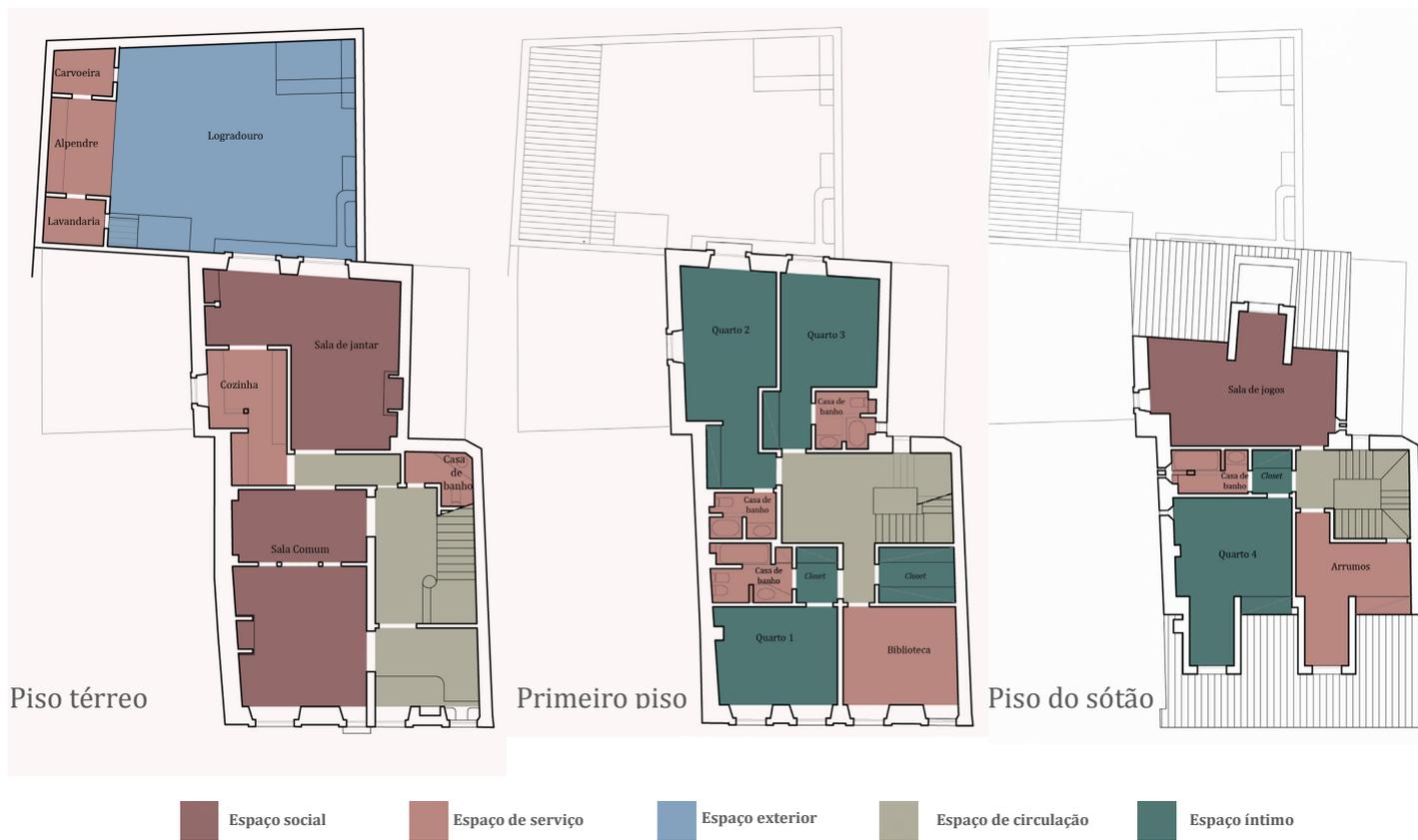
Imagem 51: Plantas de distribuição funcional de 1998. À esquerda planta de piso térreo, ao centro planta do primeiro piso e à direita planta de sótão. Desenhos realizados com base no projeto de 1998.
