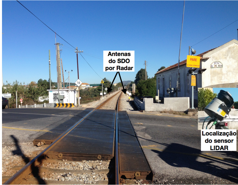
FIGURA 4.2: A imagem ilustra o contexto da PN, com a indicação da localização do sensor LIDAR, para captura das nuvens de pontos. Também apresenta as antenas do SDO por RADAR, que está instalado na PN.
