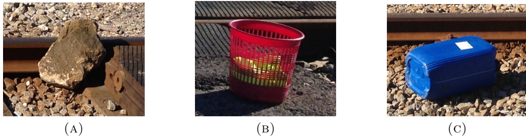
FIGURA 4.3: Alguns dos tipos de obstáculos de baixa volumetria considerados nos testes: (a) Pedra ( \approx 10 \text{ dm}^3 ); (b) Cesto de papéis ( \approx 20 \text{ dm}^3 ); (c) Jerrican ( \approx 50 \text{ dm}^3 ).
