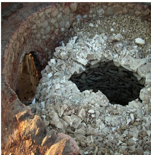
Fig.59 - Idem , carregamento do forno com mármore «cascalva» e «olho-de-mocho». Foto: Carlos Filipe, 2010. (Investigação no âmbito do projecto História da Indústria dos Mármore s).
