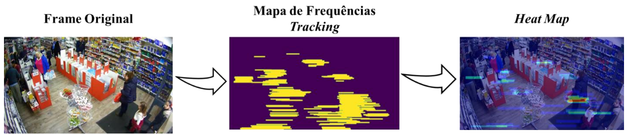
Figura 12 - Exemplo de transição de um frame original para heat map
