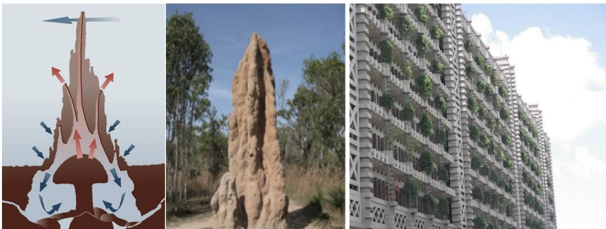
15. Analogia com as construções de térmitas no edifício Eastgate Center, no Zimbabwe. Fonte: retirado de <https://inhabitat.com/building-modelled-on-termites-eastgate-centre-in-zimbabwe/>
