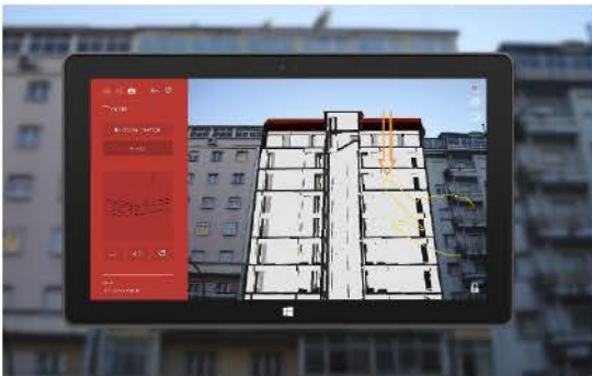
Figura 15 - SeeARch com menu lateral de Seções ativo e a mostrar um corte em tempo real no modelo 3D do edifício. (Raposo, 2016)
