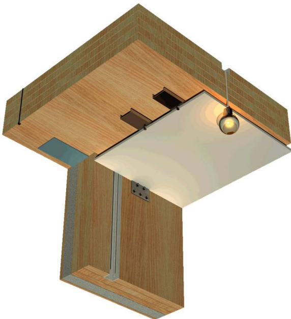
Figura 71 X-LAM aplicação de tecto-falso e rasgos para iluminação
