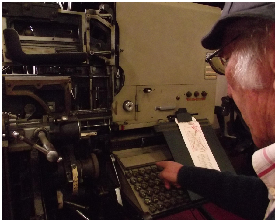
Ilustração 2.3- Florêncio sentado numa máquina de composição mecânica linotype 78, modelo igual ao que operava no D.N., 2014, Museu Nacional da Imprensa. Fotografia de autoria própria
