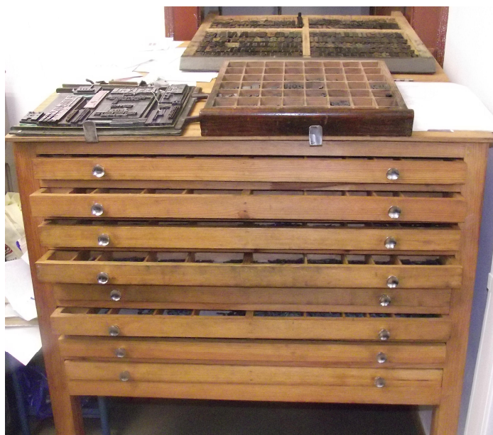
Ilustração 2.1- Caixotim, primeiro ferramenta que tinha de ser dominado pelos aprendizes de tipografia, Museu Nacional da Imprensa, 2014.
